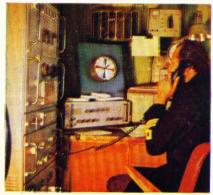
Die Treffsicherheit und die Frequenzkonstanz des Empfängers bestimmt ein temperaturkompensierter Quarzoszillator (TCXO). Die Frequenzeinstellung erfolgt dekadisch in 10 Hz-Schritten. Dafür werden Analyseoszillatoren mit einstellbaren Teilern verwendet.
