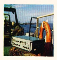
Dekadische Frequenzeinstellung und Frequenzanzeige in 10 Hz-Schritten durch 7-stelligen Schalterblock
